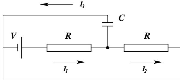
Wir betrachten den im Bild gezeigten RC-Schaltkreis. Die angelegte Spannung  $V(t)$  kann zeitabhängig sein. Die kirchhoffschen Regeln führen zur Bewegungsgleichung
