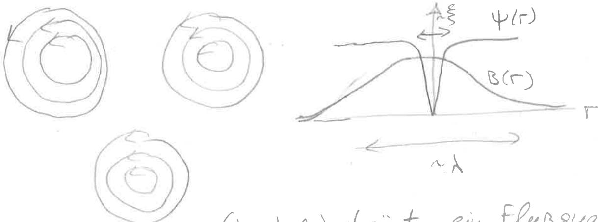
Jeder Schlauch (Wirbel) trägt ein Flussquant
